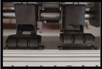
Birbirinden bağımsız çalışabilen pinch roller
